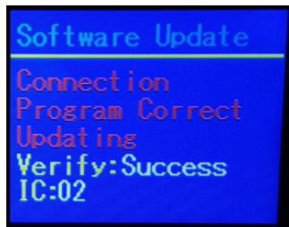
7. Retirer la clé et vérifier les versions de software en pressant « Mode » > « Information » > « Software. V » > « Enter »
